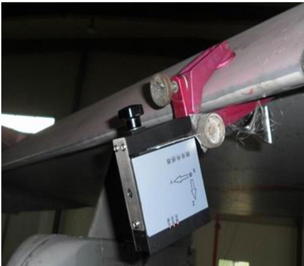
图 5-17 研制的“飞机活动舵面偏转角测量仪”
