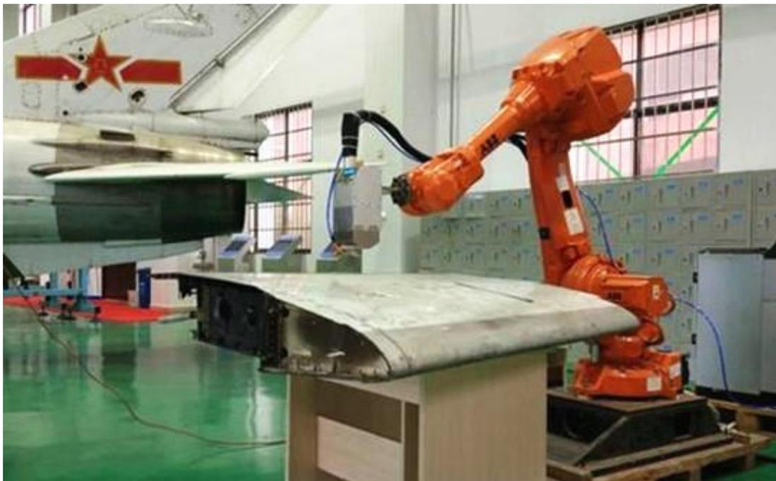
图 5-13 激光器工程化与清洗应用中的关键技术课题试验场景
